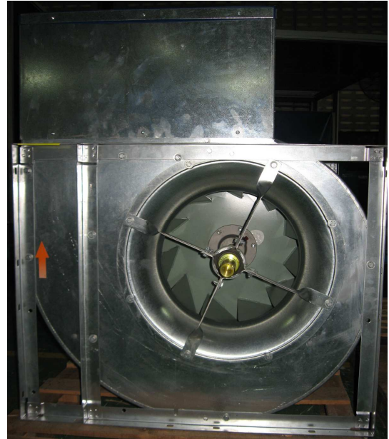
Figure 6: Plenum fan & DWDI centrifugal fan
